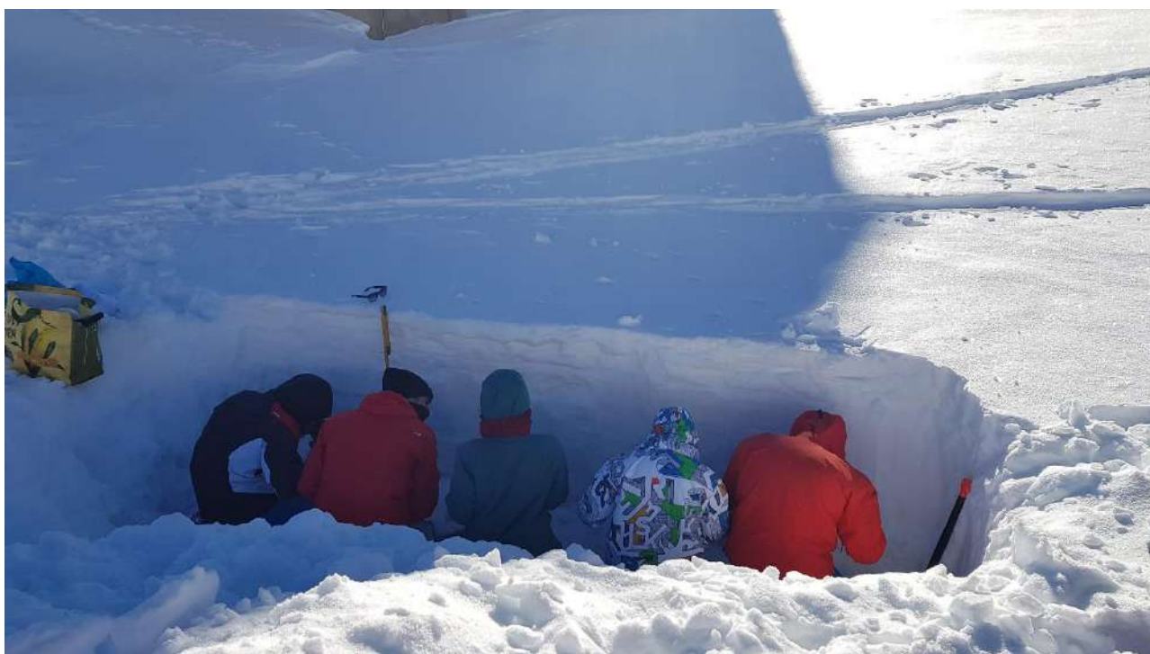
Figura 5: Operazioni di scavo e campionamento. Profilo nivologico realizzato il 21/12/2021 in occasione dell'esercitazione con gli studenti dell'Università degli Studi di Torino.
