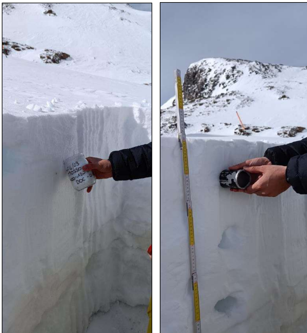
Figura 5: Operazioni di scavo e campionamento durante l'apertura del profilo nivologico realizzato il 14/04/2023.
